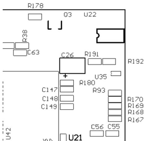
图 1-4. COM2 RS232/RS485 配置电阻位置 (背面右上角)
